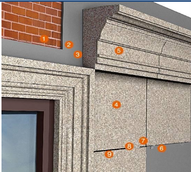
建筑保温装饰一体化材料系统构造
